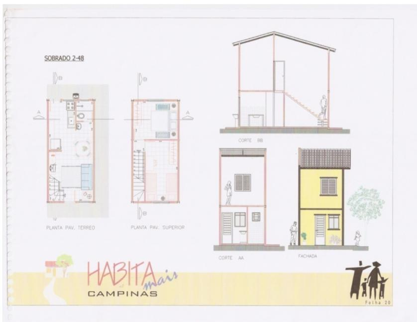
Figura 11 – Tipologia de Sobrado 2-48 utilizado na construção de novas unidades habitacionais durante a Regularização Fundiária. Fonte: SEHAB,2006.
